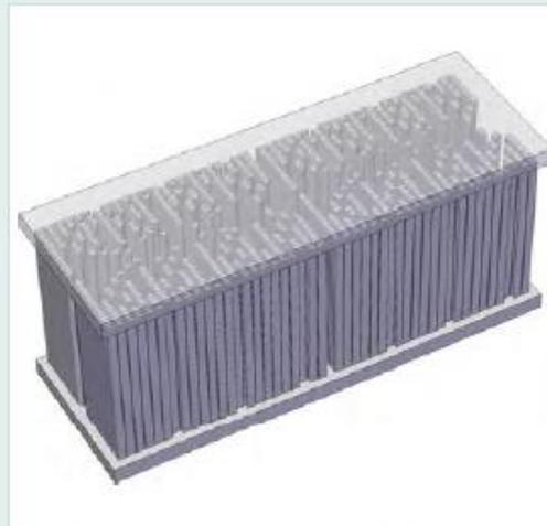
Refraktive Röntgenlinse mit Deckel- und Bodenplatte.
